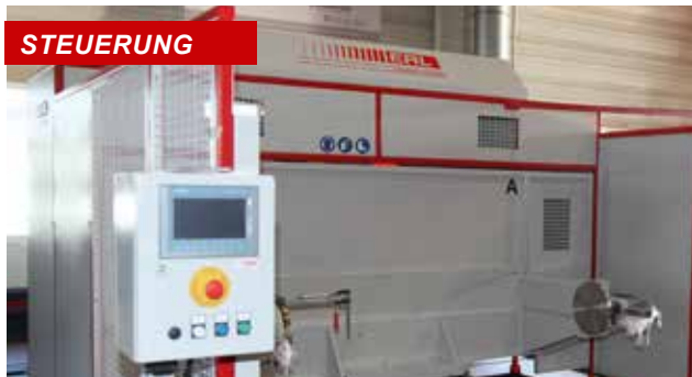
Frontseitig am Schutzzaun kann eine Steuerungseinheit angebracht werden, die den Anlagenführern bei der Bedienung viel Zeit erspart.
