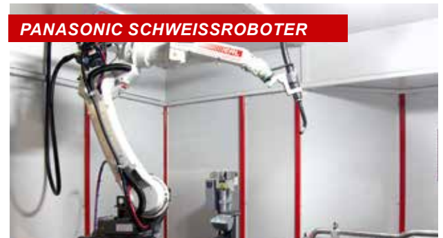
Je nach Aufgabenstellung stehen Roboter mit einer Reichweite von bis zu 3 m zur Verfügung.
