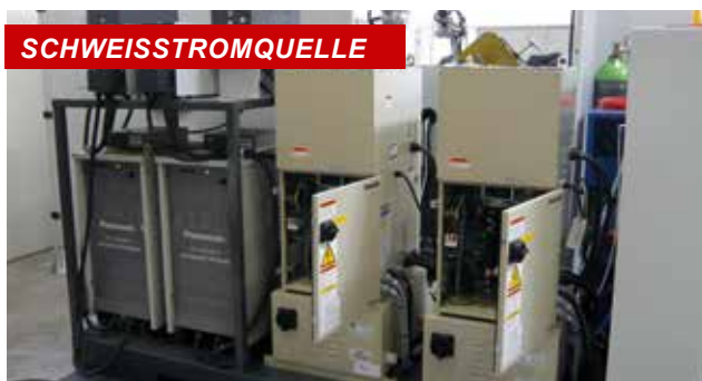
Die Roboteranlagen können mit integrierten oder separat angebotenen Stromquellen von Panasonic (wie im Bild) oder Fronius ausgestattet werden.
