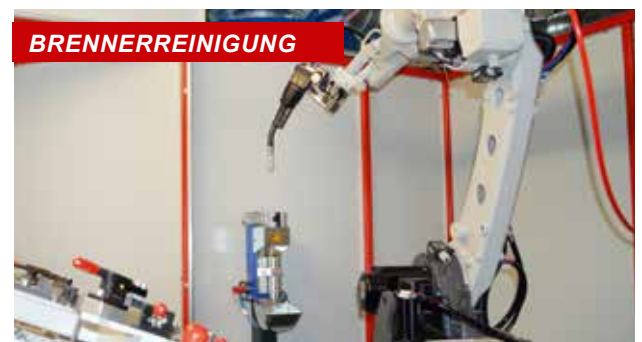
Durch intelligente Brennerreinigungssysteme kann der Gasdüsen-Innenraum automatisch von Schweißspritzern befreit werden.
